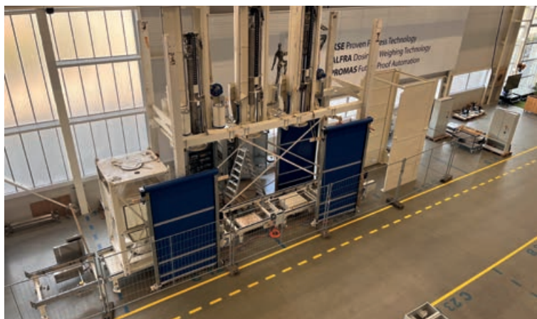
Het reinigingsysteem, Clean-in-Place (CIP), is ontwikkeld voor het schoonmaken en desinfecteren van de doseercontainers die zich bovenop de verrijdbare 'weger-in-weger-machine' voor middelgrote tot kleine componenten bevindt.
