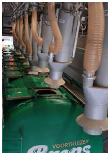
Soufflets de chargement avec extraction de la poussière.
